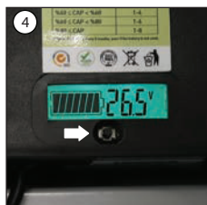
Battery voltage (20 - 26,6) Volt
